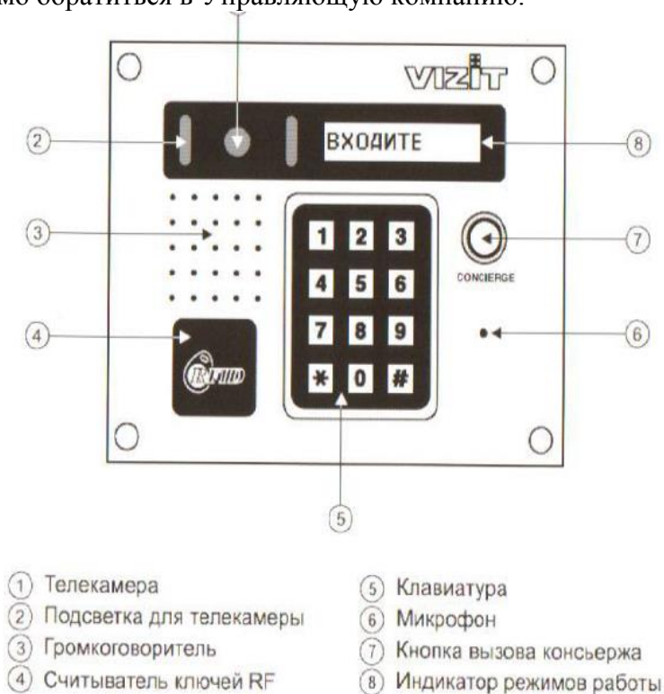
Рис. 5 Внешний вид и органы управления блока.
