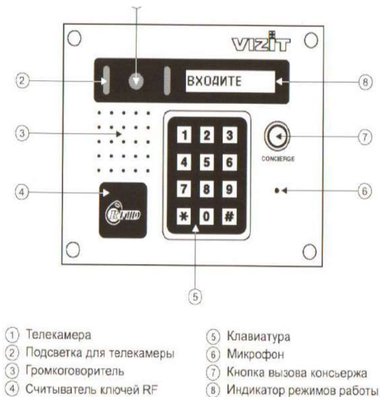
Рис. 5 Внешний вид и органы управления блока.
